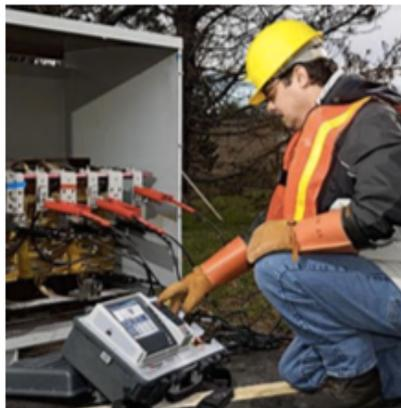
Se realizan actividades prácticas utilizando Instrumentos de Prueba Omicrom CPC100 a un transformador de distribución dispuesto por el Cliente y otros equipos de aplicación para mantenimiento.
